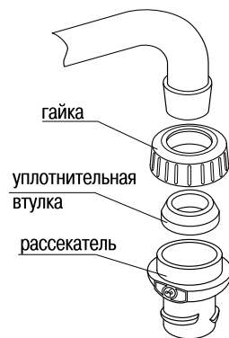
Рис. 2. Установка переходной втулки для гладкого крана.
