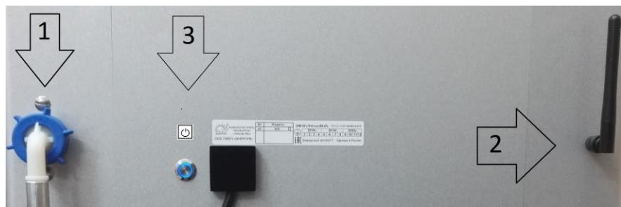
**Работа автодолива:** При отсутствии воды светится индикация "Низкий уровень воды". Клапан включён, происходит подача воды. По мере наполнения загорится индикация 3. Когда уровень воды достигнет номинального значения, загорится индикация 2. Клапан отключит подачу воды. По мере испарения, уровень воды будет снижаться. Когда погаснет индикатор 2, включится подача воды и т.д.
